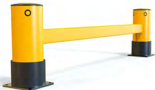
Conçu pour protéger l'extrémité des allées de rayonnage où les virages des chariots et équipements peuvent endommager les structures de rayonnage vulnérables. La version Single Rail absorbera et déviara les contacts répétés des chariots avec des centres de gravité plus bas, évitant ainsi d'endommager les systèmes de rayonnage.
