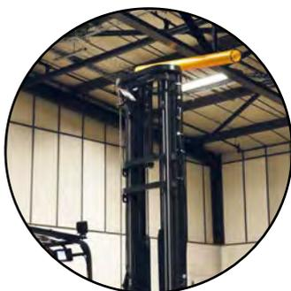
Protégez les infrastructures basses dans les environnements où des véhicules de grande hauteur tels que des chariots élévateurs sont en service.
