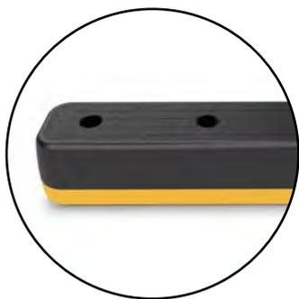
Le produit Monoplex double couche offre une couche supérieure plus douce qui dissipe l'énergie tandis que la couche inférieure plus dure assure la rigidité autour des trous de fixation. Cela garantit que le Step Guard reste solide en cas d'impact et répartit l'énergie sur l'ensemble du produit, réduisant ainsi le risque de dommages et minimisant le risque que les fixations s'arrachent du sol.
