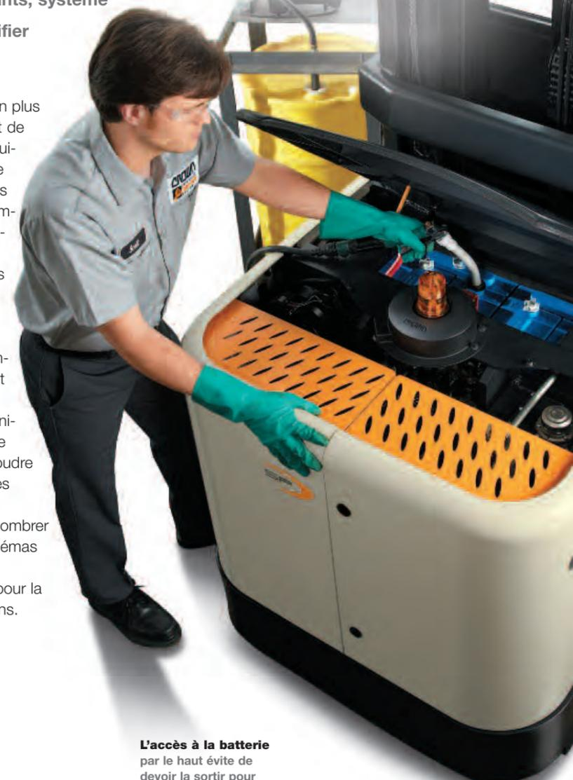
**L'accès à la batterie** par le haut évite de devoir la sortir pour ajouter de l'eau, vérifier les niveaux de l'électrolyte, mesurer la tension ou effectuer toute autre tâche d'entretien.
