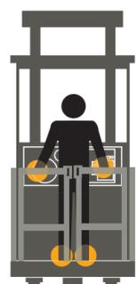
**Les quatre points de contact solides sur la série SP 3500, avec poignée fixe à droite, augmentent la stabilité du cariste et lui permettent de se sentir plus à l'aise en hauteur.**
