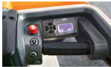
03 Les commandes de vitesse de déplacement et de la plateforme du cariste se trouvent sur la droite du cockpit
