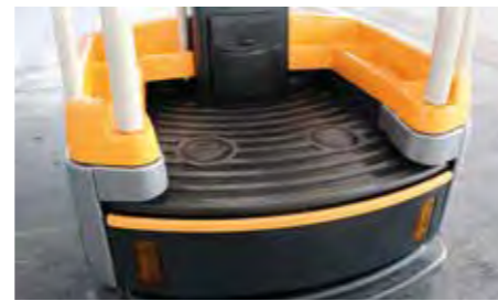
05 La plateforme du cariste offre une assise sûre – avant de pouvoir démarrer le chariot, le cariste doit positionner chaque pied dans un cercle clairement marqué
