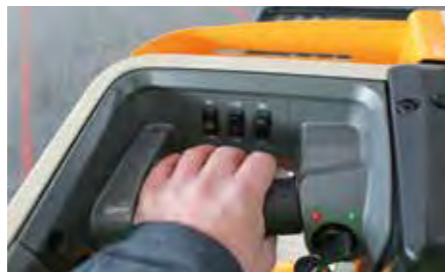
04 La main gauche est utilisée pour piloter, pour contrôler la hauteur du plateau de chargement, sélectionner le mode « au pas » et commander les feux de travail
