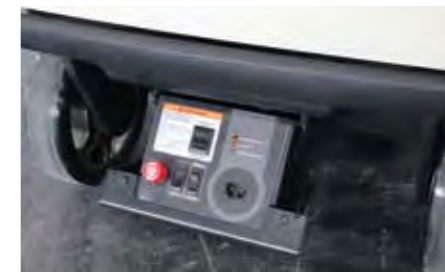
07 La batterie peut être rechargée depuis une prise électrique ordinaire – un câble de charge intégré est disponible en option
