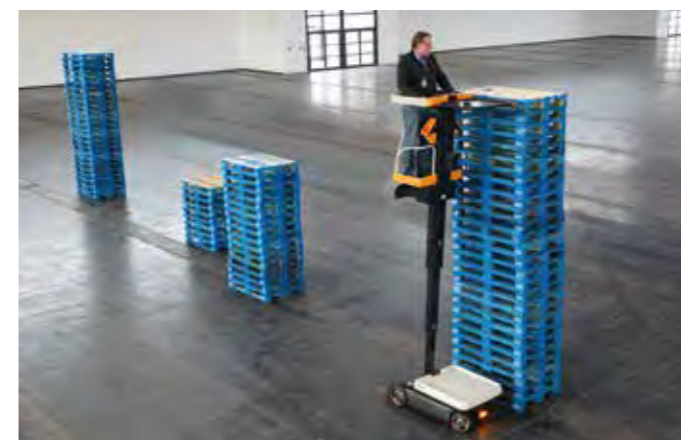
01 La plateforme du cariste peut être soulevée hydrauliquement à une hauteur de 2 995 mm
