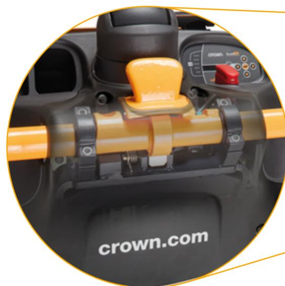
**Nos protections latérales ultrarésistantes sont composées de tubes en acier à paroi épaisse de 50 mm de diamètre et d'un solide système de fixation à base de presses en C.**
