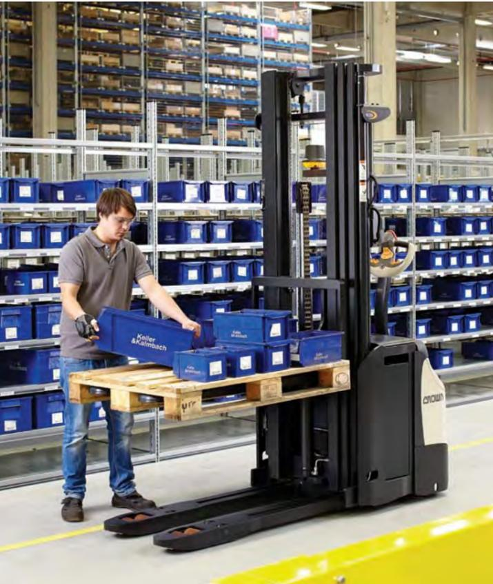
Le levage télécommandé à distance permet aux opérateurs des gerbeurs accompagnants Crown d'avoir une main supplémentaire disponible pour l'exécution de travaux manuels. Considérons les avantages que les opérateurs ont tirés lors de l'utilisation de QuickPick Remote.
