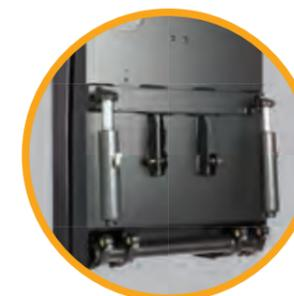
**Deux vérins de levage** (uniquement sur certains modèles) associés à une barre de torsion hautement résistante suppriment la torsion du châssis lors de la manutention de charges excentrées.
