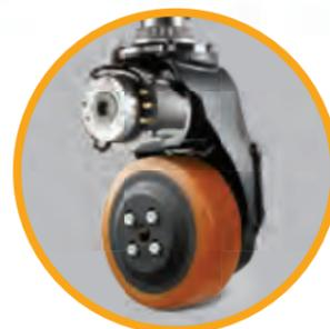
**Le système de freinage Intelligent e-GEN®** utilise la puissance du moteur AC pour offrir le niveau optimal de freinage régénératif sans friction.
