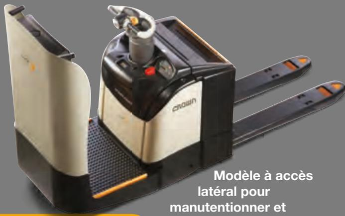
Modèle à accès latéral pour manutentionner et scanner plus facilement les charges : accès rapide et distance plus courte jusqu'aux palettes. Dossier d'appui pour plus de protection et de confort, très adapté à la préparation de commandes.
