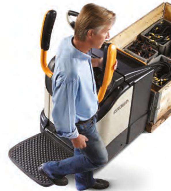
**Les protections latérales de Crown** permettent au cariste de descendre sur le côté, pour gagner du temps et raccourcir les trajets à pied.
