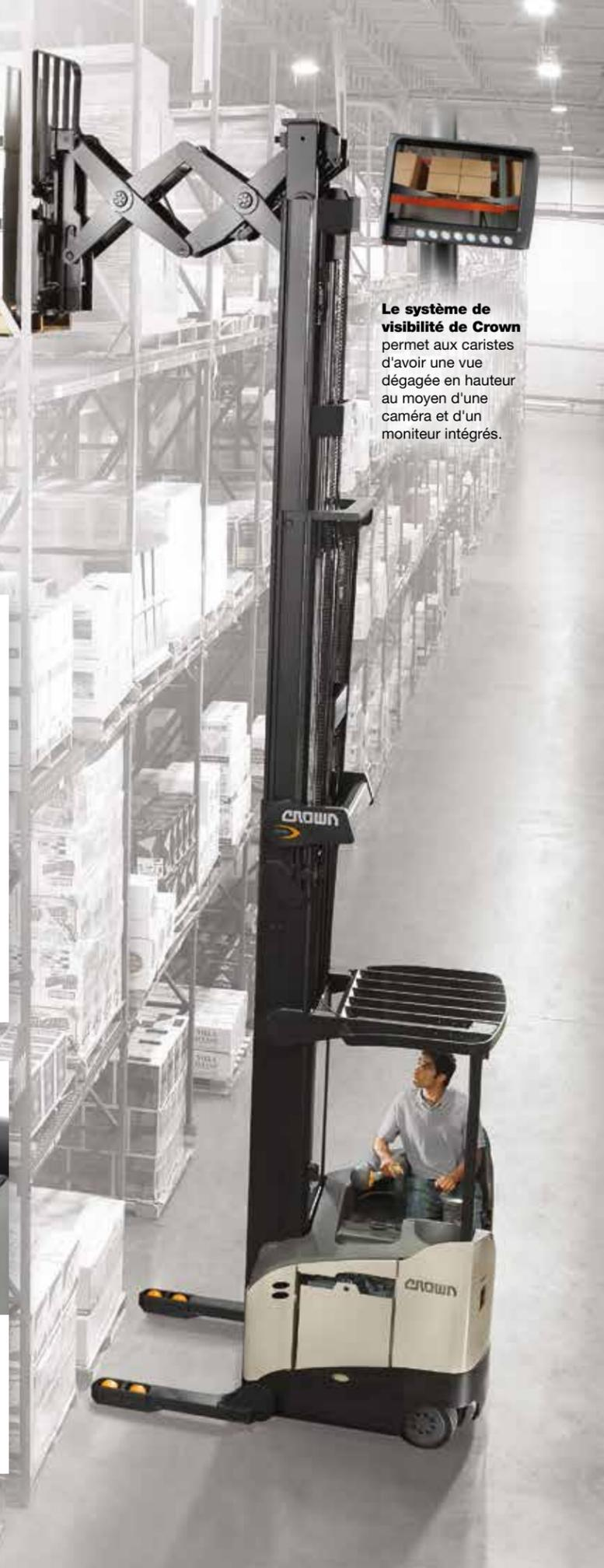
**Le système de visibilité de Crown** permet aux caristes d'avoir une vue dégagée en hauteur au moyen d'une caméra et d'un moniteur intégrés.
