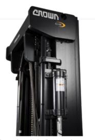
Accumulateur hydraulique en option Réduit le rebond du tablier porte-fourches lors des déplacements sur des surfaces irrégulières.
