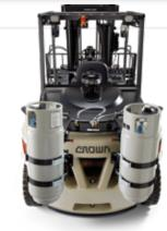
Doubles supports pivotants et abaissables de bouteille de GPL en option Pour plus de commodité, optez pour les doubles supports de réservoir pivotants et abaissables qui facilitent les remplissages.
