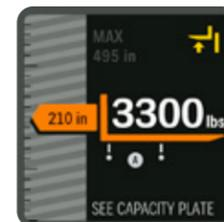
**Gris** : la charge est inférieure à la capacité et à la limite de hauteur de levée
