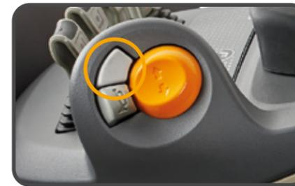
La fonction de sélection automatique de la hauteur en option permet aux fourches de s'arrêter automatiquement aux hauteurs de rayonnage programmées à l'aide du bouton de fonction ou des sélections à l'écran. Le positionnement précis et automatisé permet d'éviter d'endommager les produits, les rayonnages et les chariots élévateurs tout en augmentant le rendement.
