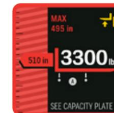
**Rouge** : la charge dépasse la capacité ou est supérieure à la limite de hauteur de levée
