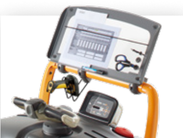
Tube avant avec grand porte-documents transparent et support à lecteur de codes-barres
