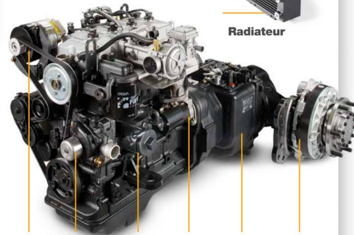
Alternateur Pompe à eau Ensemble du moteur Démarreur Transmission Freins assistés
