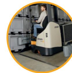
**Tenue de rampe** – maintient le chariot stationnaire en pente et dans les rayonnages de type « Push back » jusqu'à ce qu'une commande de déplacement soit émise
