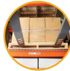
**Guidage des fourches laser** – cette option permet de positionner facilement les fourches en hauteur pour plus de précision et de productivité
