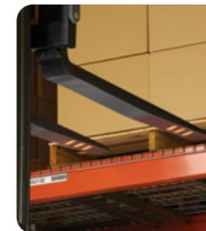
L'option d'assistance à l'inclinaison des fourches, proposée sur la série ESR, compense la déflexion du mât et du tablier pour mettre automatiquement les fourches de niveau par rapport au sol, afin d'améliorer encore la précision du positionnement.
