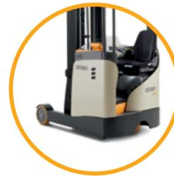
**Longerons étroits** – les charges d'une largeur maximale de 39 pouces s'insèrent entre les longerons sans augmenter la largeur totale du chariot
