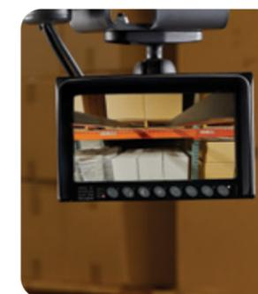
Options de caméra au niveau des fourches ou du mât pour faciliter la manutention et le positionnement des fourches.
