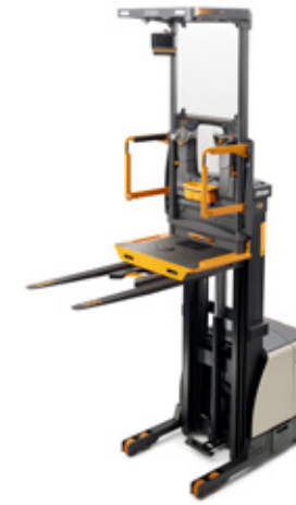
Série SP 1500 Préparateur de commandes Capacité de charge : 3 000 lb Hauteur de levée : 136 à 402 po
