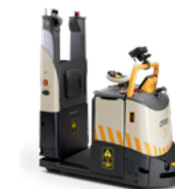
DualMode Série T 1000 Tracteur électrique Capacité de charge roulante : 11 000 lb
