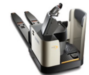
Série PR 4500 Chariot à conducteur porté Capacité de charge : 6 000 et 8 000 lb Fourches : longueurs double et triple disponibles
