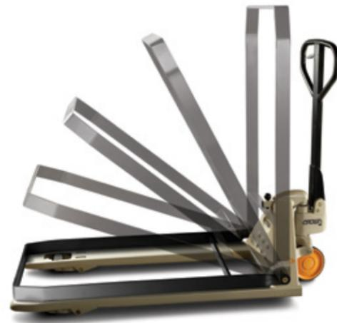
Le raccord de patin augmente la hauteur abaissée à 5,5 po pour permettre la prise en charge des patins. La hauteur levée passe alors à 10,5 pouces. L'adaptateur se bloque en position verticale pour les tâches de maniement de palettes.
