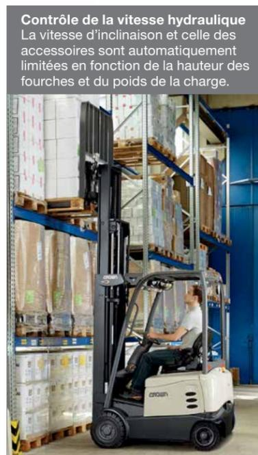
**Contrôle de la vitesse hydraulique**
