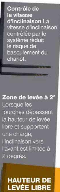
**Contrôle de la vitesse d'inclinaison** La vitesse d'inclinaison contrôlée par le système réduit le risque de basculement du chariot.
