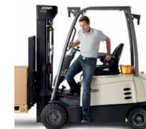
Le cariste monte et descend du chariot aisément grâce à la faible hauteur de marche, au plancher spacieux et au support de siège sculpté. Le toit de protection profilé offre plus d'espace au niveau de la tête.
