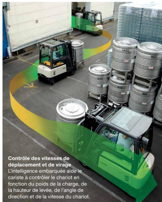
**Contrôle des vitesses de déplacement et de virage**
