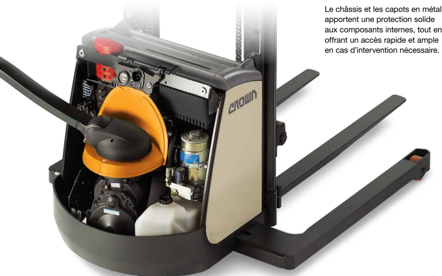
Le châssis et les capots en métal apportent une protection solide aux composants internes, tout en offrant un accès rapide et ample en cas d'intervention nécessaire.
