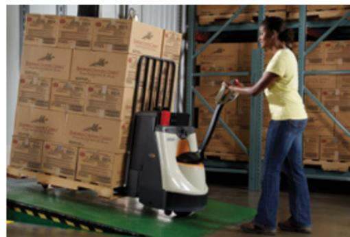
**La tenue de rampe de Crown améliore la confiance et le contrôle du cariste** en réduisant la possibilité d'une marche arrière inattendue en cas d'arrêt sur une pente. Elle permet également une vitesse constante sur les rampes, avec ou sans charge.
