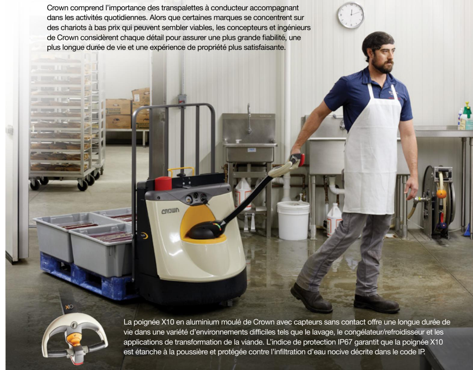
La poignée X10 en aluminium moulé de Crown avec capteurs sans contact offre une longue durée de vie dans une variété d'environnements difficiles tels que le lavage, le congélateur/refroidisseur et les applications de transformation de la viande. L'indice de protection IP67 garantit que la poignée X10 est étanche à la poussière et protégée contre l'infiltration d'eau nocive décrite dans le code IP.
