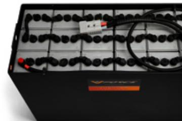
**Tubulaire** Conception avancée qui augmente la surface de matériau actif, prolongeant ainsi le temps de service pour une productivité accrue. Les connecteurs intercellulaires boulonnés simplifient l'entretien en permettant au technicien d'isoler, de retirer et de remplacer les cellules tout en minimisant le risque d'étincelle ou d'inflammation. Options pour les cellules à haute capacité ou les cellules standard avec des besoins de remplissage réduits.
