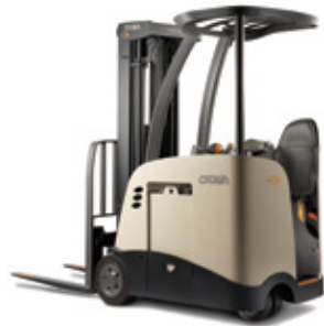
Série RC 5700 Pneu : À bandages creux Alimentation : Électrique de 36 V Capacité de charge : 3 000 à 4 000 lb Hauteur de levé : 112 à 282 po
