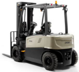
Série C-B, modèles 40-50 Pneu : À bandages pneumatiquespleins Alimentation : Électrique de 80 V Capacité de charge : 8 000 à 10 000 lb Hauteur de levée : 118 à 238 po
