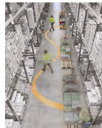
Per applicazioni con commissionatore orizzontale, le tecnologie di commissionamento **QuickPick Remote** utilizzano la tecnologia wireless per fare avanzare il carrello da remoto. Riducendo la frequenza con cui l'operatore è obbligato a salire e scendere dal carrello, questa funzione di assistenza contribuisce ad aumentare la sicurezza, riduce la fatica per l'operatore e migliora la produttività, consentendo di risparmiare fino a cinque secondi a prelievo.
