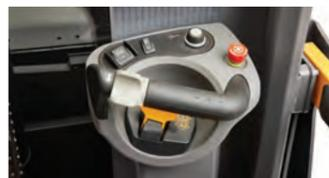
Il set di comandi di destra consente all'operatore di combinare con facilità le diverse funzioni del carrello, mantenendo sempre quattro stabili punti di contatto. La manopola di navigazione display opzionale offre un altro metodo di navigazione sullo schermo.
