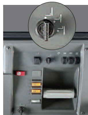
Interruttore di selezione delle zone Impostazione sicura di tre limiti di sollevamento predefiniti.
