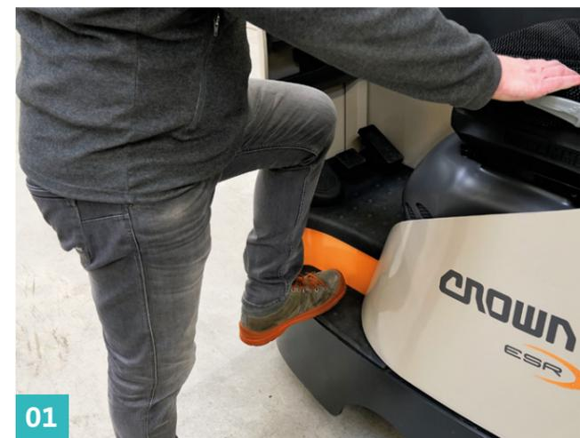
01 Il vano di entrata/uscita è spazioso e offre un accesso sicuro alla cabina dell'operatore
