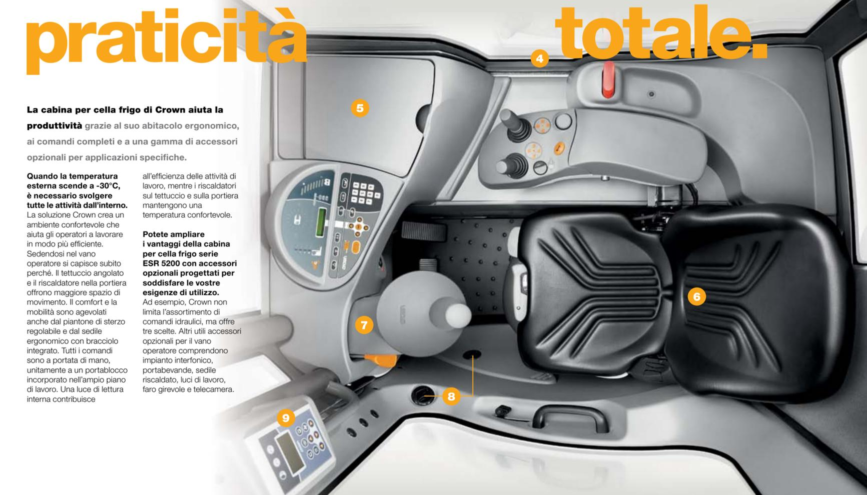
**1 Riscaldatore sul tettuccio** - Tre bocchette di ventilazione orientabili erogano aria calda dal riscaldatore con ventilatore, comandato da sensore.
