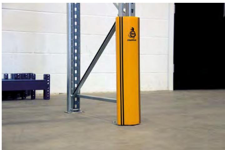
Le protezioni RackGuard assorbono e deviano gli impatti, trasferendo l'energia intorno al montante della scaffalatura anziché attraverso di esso, prevenendo i danni ai montanti e mantenendo l'integrità strutturale dei sistemi a scaffalatura. I punti di presa a frizione assicurano un'aderenza sicura al montante della scaffalatura di qualsiasi dimensione. RackGuard viene fornito con un kit strumento appositamente sviluppato per un'installazione ultra-rapida.
