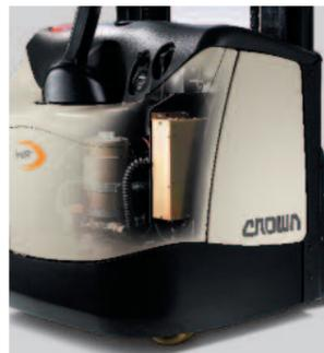
**Caricabatteria integrato:** ogni modello Crown è equipaggiato di serie con un caricabatteria ad alta frequenza a stato solido da 30 ampere.
