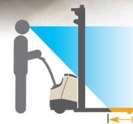
**Il corpo macchina inclinato e di altezza ridotta e il design del montante a vista libera** dei sollevatori Crown offrono eccellente visibilità sull'estremità delle forche (in genere il 50 per cento della loro lunghezza totale).
