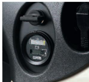
**Indicatore di carica/scarica batteria:** include l'esclusione del sollevamento al raggiungimento dell'80% di scarica della batteria e con contatore incorporato.
