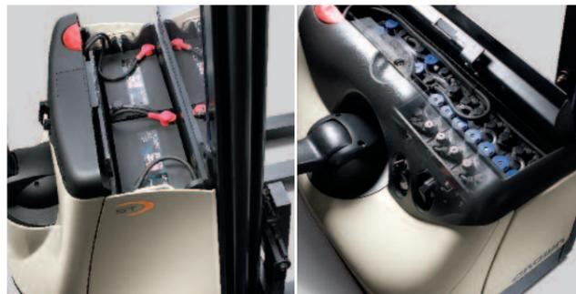
**Vari accessori per batteria:** le batterie Crown possono contare su molti accessori, tra cui batterie da trazione con elettrolita al gel con capacità fino a 192 Ah e batterie da trazione con elettrolita liquido fino a 180 Ah (nella figura con autorabbocco opzionale).
