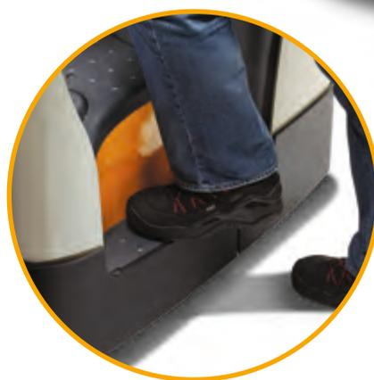
**Il gradino di accesso ribassato** facilita il saliscendi dal carrello, riducendo lo sforzo per l'operatore e aggiungendo un ulteriore livello di sicurezza.
