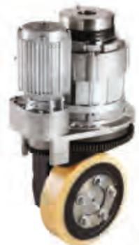
**I motori Crown** sono progettati e fabbricati per durare più a lungo, hanno un sistema di raffreddamento notevolmente superiore e offrono maggiore efficienza nelle applicazioni più gravose.
