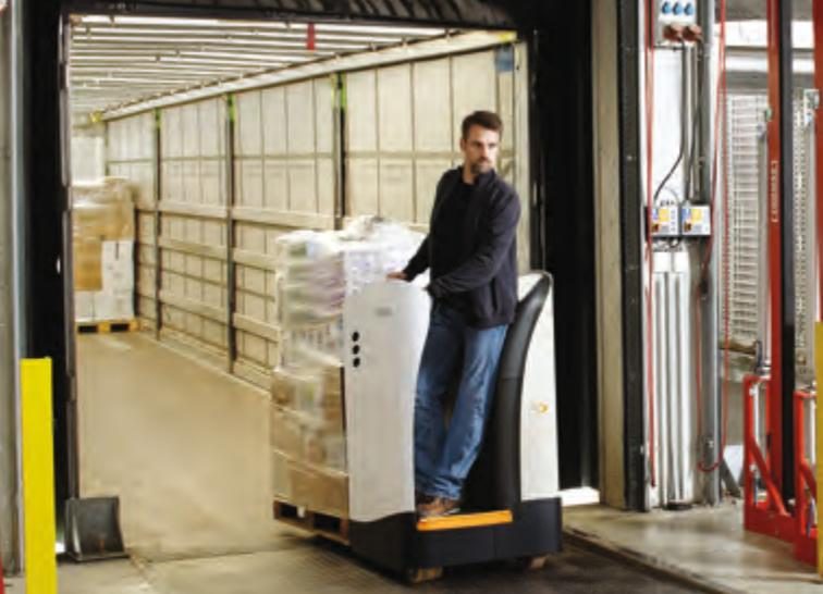
**Operazioni di carico/scarico più rapide** – Grazie all'eccezionale manovrabilità del transpallet con operatore a bordo in piedi serie RT, dotato di comandi intuitivi, pianale sospeso e telaio di soli 780 mm di larghezza, gli operatori possono eseguire più rapidamente le operazioni di carico e scarico dai camion.
