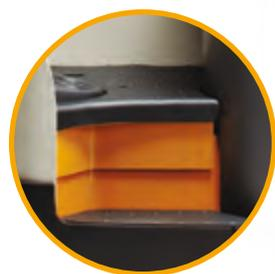
**Un pianale regolabile in altezza** con corsa di 60 mm consente all'operatore di selezionare una posizione ideale per il comfort.
