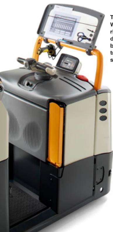
Tubo accessori Work Assist anteriore con gestione dei cavi, ampio blocco portafogli trasparente e porta scanner a pistola
