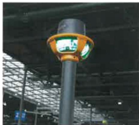
L'accensione della luce verde indica che il carrello è pronto per le operazioni comandate a distanza.
