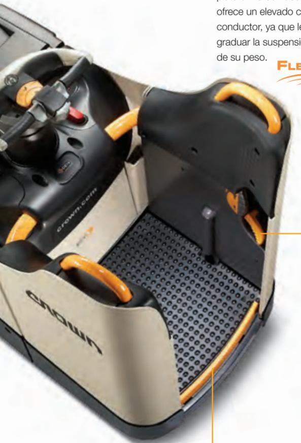
El interruptor de seguridad de la Barra Perimetral® favorece la seguridad del operario. Cuando el operario pone el pie sobre él, la máquina reduce la velocidad automáticamente.
