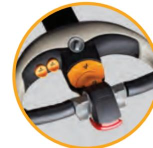
El timón X10® de aluminio fundido también contribuye a la durabilidad del conjunto y combina suavidad y precisión en el posicionamiento de palés mediante funciones de elevación y descenso proporcionales.
