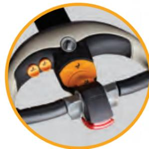
El timón X10 de aluminio fundido también contribuye a la durabilidad del conjunto; combina suavidad y precisión en el posicionamiento de palés mediante funciones de elevación y descenso proporcionales.
