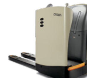
Serie RT 4000 Transpaleta de operador a bordo Capacidad de carga: 2,000 kg Horquillas: largos dobles disponibles
