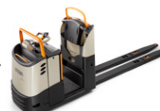
Serie GPC 3000 Selector de pedidos de bajo nivel Capacidad de carga: 2,700 kg Levante de la plataforma disponible Disponible con lo siguiente: • Sistema QuickPick Remote
