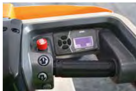
03 De bedieningselementen voor de rijsnelheid en het bestuurdersplatform zitten rechts
