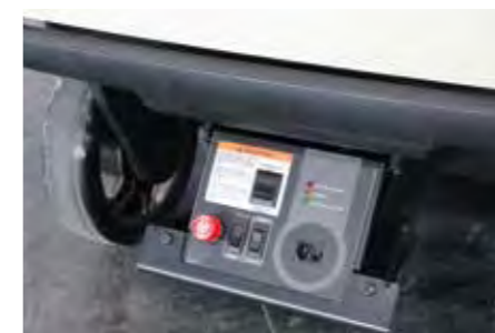
07 De batterij kan via een standaard stopcontact worden opgeladen – een geïntegreerde laadkabel is als optie verkrijgbaar
