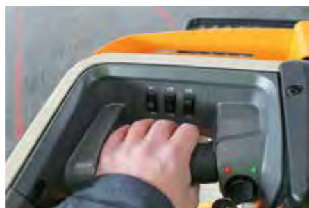
04 Met de linkerhand kun je sturen, de hoogte van het laadplateau en de kruipmodus instellen en de werkverlichting bedienen
