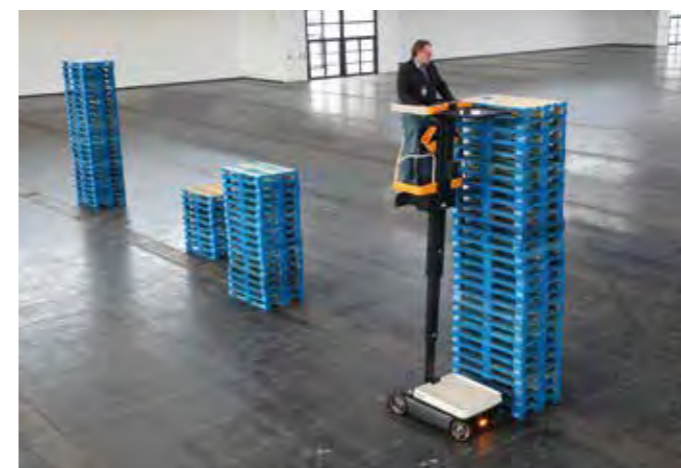
01 Het bestuurdersplatform kan hydraulisch tot op een hoogte van 2.995 mm worden gebracht
