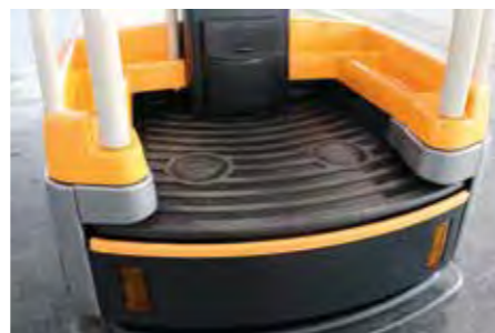
05 Het bestuurdersplatform zorgt ervoor dat de bestuurder stevig staat – de truck start pas nadat je bewust op de ronde markeringen hebt gestapt
