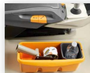
**Uma bandeja magnética de armazenamento** para peças pequenas pode ser colocada em vários locais na empilhadeira. Outros acessórios opcionais Crown Work Assist™ podem ser colocados nas barras verticais da proteção para facilitar o acesso.
