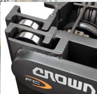
**Os mastros permanecem firmes** com a construção sólida da viga em I da Crown, que resiste a flexões e torções longitudinais, lateral e torção.
