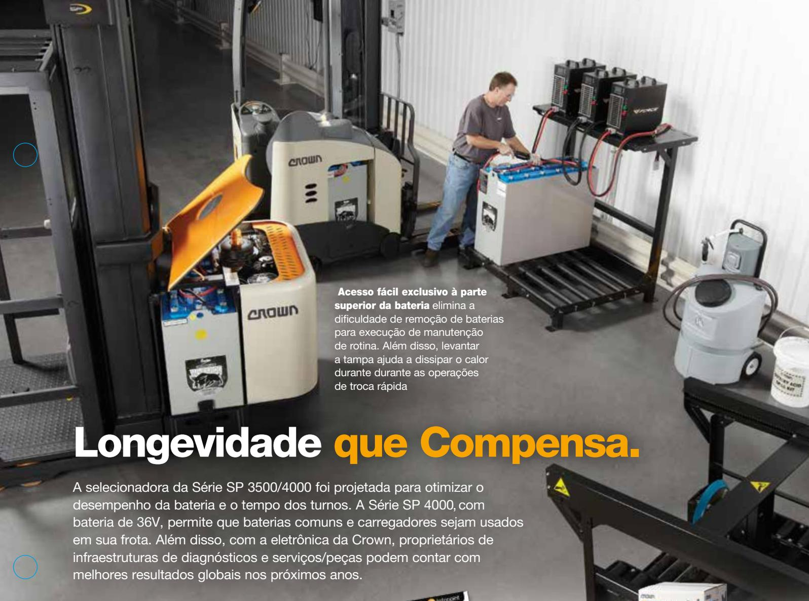
**Acesso fácil exclusivo à parte superior da bateria** elimina a dificuldade de remoção de baterias para execução de manutenção de rotina. Além disso, levantar a tampa ajuda a dissipar o calor durante as operações de troca rápida
