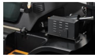
**Um compressor de ar sem tanque opcional** pode ser adicionado como uma maneira rápida e prática de limpar poeira, sujeira ou pequenos detritos do compartimento do operador.
