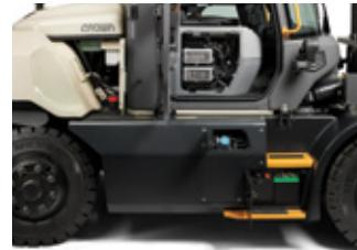
**Um compartimento do operador com inclinação total** e painéis de serviço sem necessidade de ferramentas oferecem acesso rápido aos componentes cruciais e para reabastecer consumíveis, incluindo o fluido de exaustão diesel. Todos os painéis de serviço externos incluem travas de segurança.
