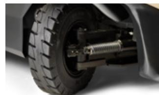
**Fusos da direção grandes e resistentes** com pinos mestre e rolamentos de roletes cônicos vedados absorvem impactos e mantêm as peças móveis livres de contaminação. Uma viga de eixo de ferro fundido espessa proporciona força e durabilidade.
