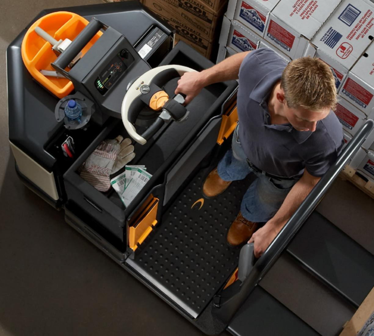
A direção elétrica assistida permite que o operador trabalhe em uma posição lateral confortável para inserir paletes ou manobrar em espaços congestionados. As opções de Work Assist™ como a seleção de pedidos em segundo nível, portacopos e o módulo de armazenamento montado na bateria contribuem para a eficiência e produtividade do operador.
