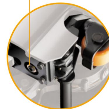
**As rodas câsters de ajuste rápido** permitem um ajuste rápido e fácil para compensar o desgaste normal das rodas de tração. Basta soltar a contraporca e ajustar a altura da roda câster com uma chave Allen.
