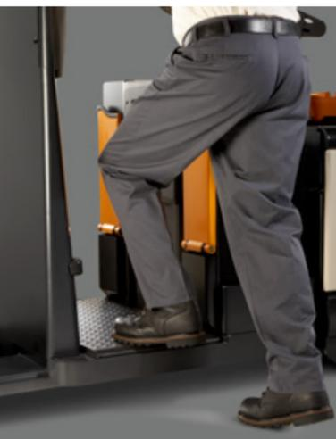
A plataforma na Série PC 4500 para em uma altura predeterminada sempre que os garfos são elevados para oferecer uma altura de degrau consistente para os operadores.
