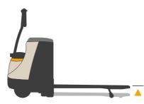
O corte de elevação em elevação total interrompe o motor assim que seja alcançada a elevação completa. Isto reduz o consumo de energia e estende a vida útil do componente.
