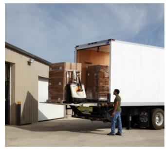
Milhares de aplicações sem docas de recebimento/ expedição precisam de carregamento da empilhadeira para a calçada por meio de comportas levadiças. O design compacto da Crown e a manobrabilidade com desbloqueio do freio com controle de velocidade e função com braço de comando na vertical tornam a Série WP 3200 ideal para essas aplicações.
