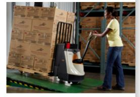
A parada em rampa da Crown melhora a confiança e o controle do operador reduzindo a possibilidade de deslocamento reverso inesperado quando parada em uma inclinação. Ela também permite uma velocidade consistente nas rampas, com ou sem carga.
