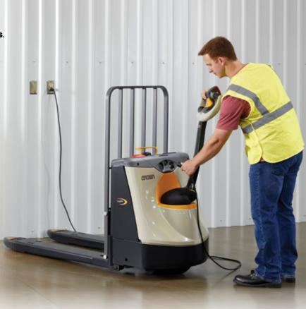
O carregador integrado vedado, versátil o suficiente para trabalhar com baterias de íon de lítio e de chumbo-ácido, praticamente elimina a entrada de contaminação, que pode resultar em falha.
