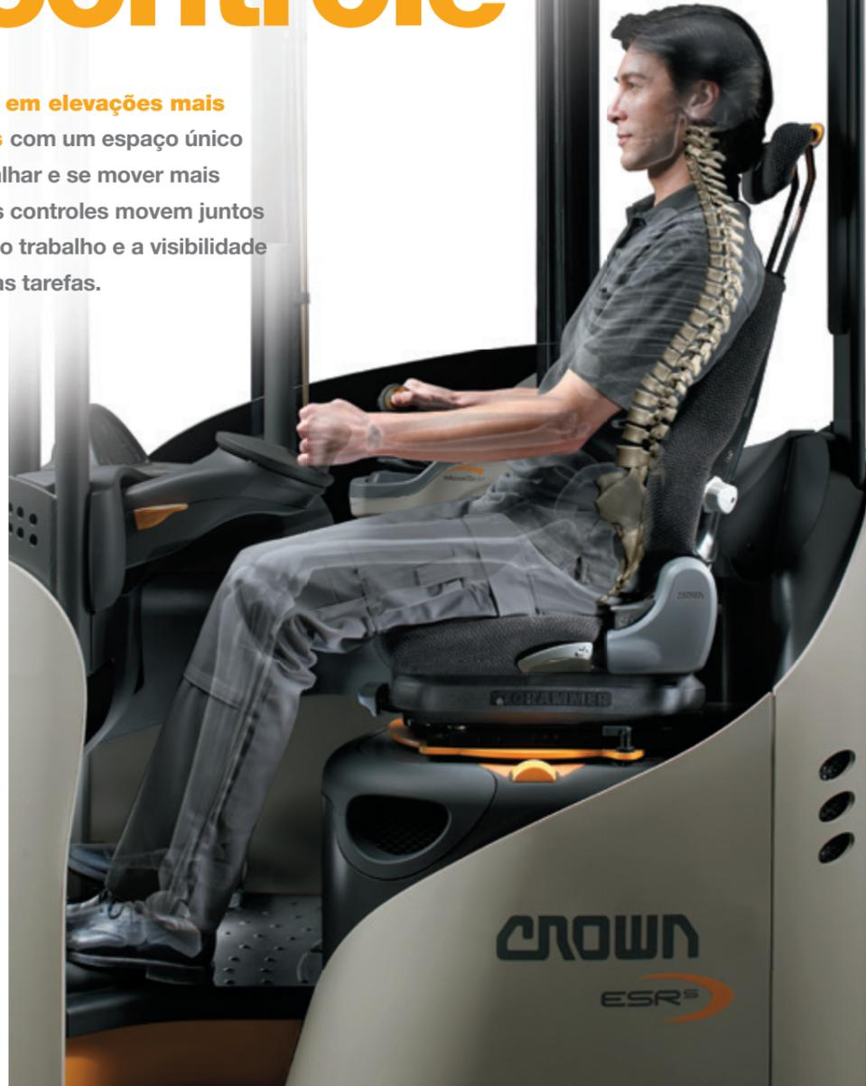
O MoveSeat gira 10 graus a partir da posição neutra para melhorar a visibilidade quando se desloca com a unidade de potência à frente. Quando se desloca com os garfos à frente, o assento gira 20 graus da posição neutra, melhorando a visibilidade para a frente e para cima dos garfos.
