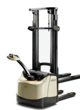
Série WF 3200 Empilhadeira patolada com garfo Capacidade de carga: 1.200 kg Altura de elevação: 1.550 a 4.400 mm
