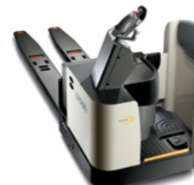
Série PR 4500 Transpaleteira com operador embarcado Capacidade de carga: 3.640 kg Garfos: comprimentos duplos e triplos disponíveis
