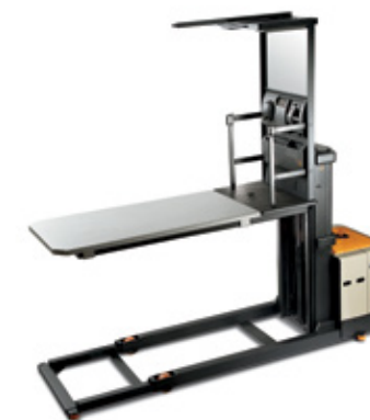
Série SP 3570F Patoladas Capacidade de carga: 1.360 kg Altura de elevação: 5.335 a 9.295 mm
