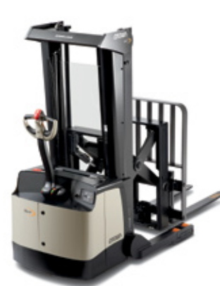
Série SHR 5500 Empilhadeira patolada pantográfica a pé de alta capacidade Capacidade de carga: 1.130, 1.360 e 1.585 kg Altura de elevação: 3.235 a 4.875 mm
