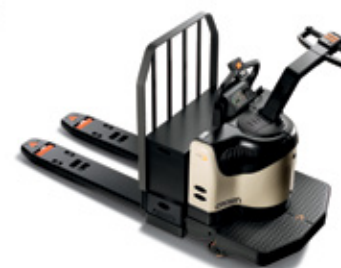
Série PE 4500 Transpaleteira com posição do operador na extremidade Capacidade de carga: 3.640 kg Garfos: comprimentos duplos e triplos disponíveis Direção assistida disponível
