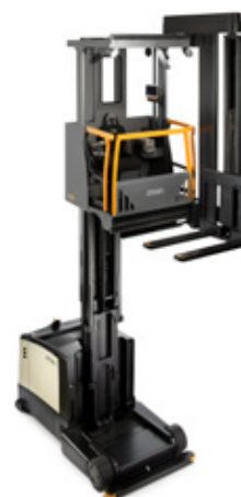
Série TSP 1000 (mostrada) Selecionadora de pedidos de torre monomastro Capacidade de carga: 1.500 kg Altura de elevação: 4.900 a 13.485 mm
