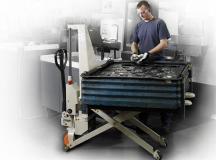
A elevação pantográfica melhora a eficiência e o conforto do operador evitando que ele se curve ou se levante desnecessariamente, o que pode causar desgastes e tensões no corpo. O sistema conta com diversos usos como paleta e mesa de trabalho, é capaz de lidar com paletes e caixas e ainda pode ser usada para segurar materiais que serão colocados em transportadoras e impressoras ou perfuradoras.
