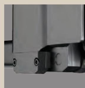
Blocos de revestimento de aço substituíveis nos saltos do garfo agem como o primeiro ponto de contato quando a altura é excedida. Isto protege a armação ao se locomover sobre superfícies irregulares, plataformas muito anguladas ou ao operar em comportas levadiças.
