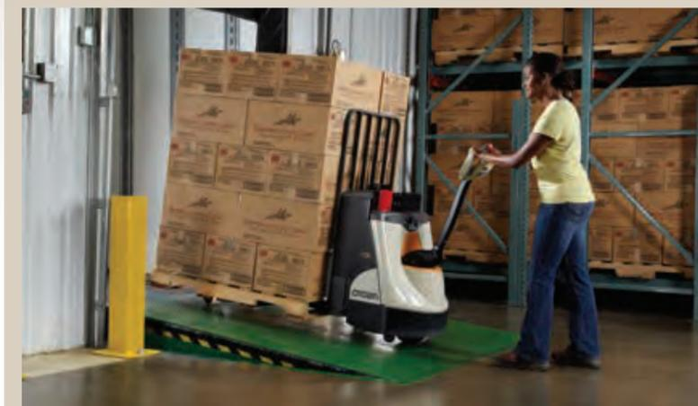
O apoio de rampa da Crown melhora a confiança e o controle do operador minimizando a possibilidade de percurso reverso inesperado quando parada em uma inclinação. Também permite uma velocidade consistente sobre rampas, com ou sem carga.
