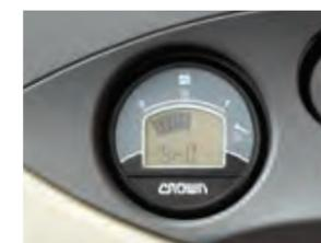
O painel padrão apresenta leitura de código de falha para identificar claramente uma falha no sistema durante a operação ou inicialização da transpaleta. Chega de suposições, o visor diz tudo.
