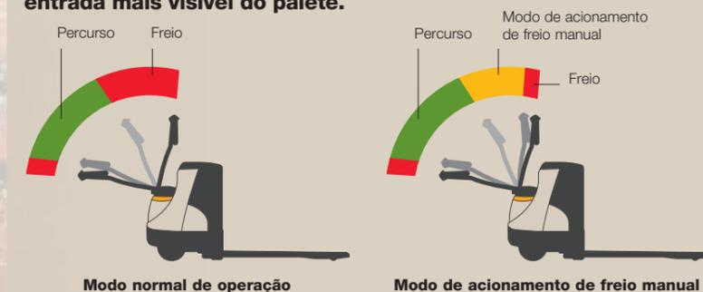
A Crown fornece aos operadores o melhor de ambos mundos: no modo normal de operação uma grande zona de freio garante que os operadores possam parar a transpaleteira facilmente e rapidamente durante operação normal. Quando estiver trabalhando em espaços estreitos, o modo de acionamento de freio manual possibilita que os operadores posicionem a manopla de direção na posição quase vertical enquanto engata a tração em velocidade lenta para o posicionamento bem alinhado da carga.
