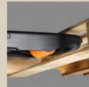
As pontas macias e arredondadas do garfo simplificam a entrada do palete e são encaixadas para agregar resistência. Além disso, o design das pontas do garfo evita o acúmulo de detritos.
