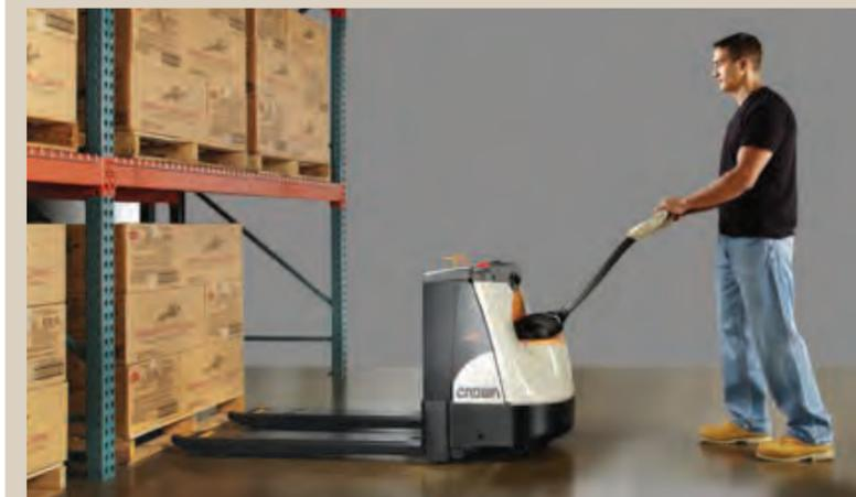
A entrada do palete é ampliada através de melhor visibilidade das pontas do garfo, resultante da combinação de uma unidade elétrica discreta e dos indicadores da ponta do garfo exclusivos da Crown.
