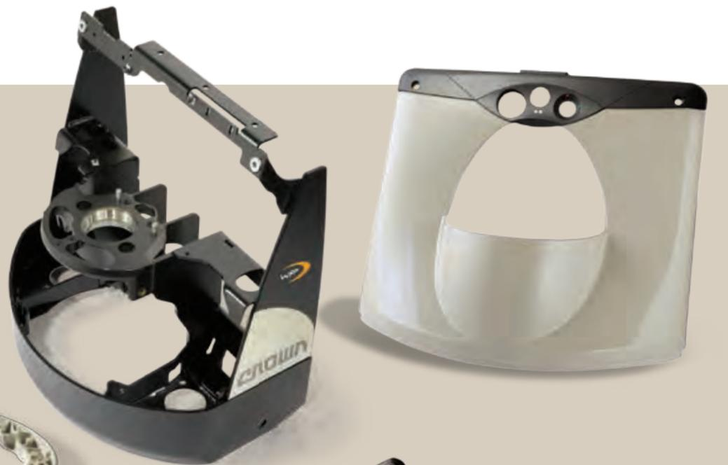
A manopla de direção X10™ de alumínio fundido concede desempenho durável em aplicações difíceis. É uma diferença crucial, pois as transpaleteiras são usadas geralmente em espaços extremamente estreitos, onde as manoplas de direção frequentemente encontram paredes, pilastras, cargas e outros objetos fixos. As manoplas de direção de plástico dos concorrentes são facilmente danificadas no impacto, o que exige reparos onerosos ou substituição.
